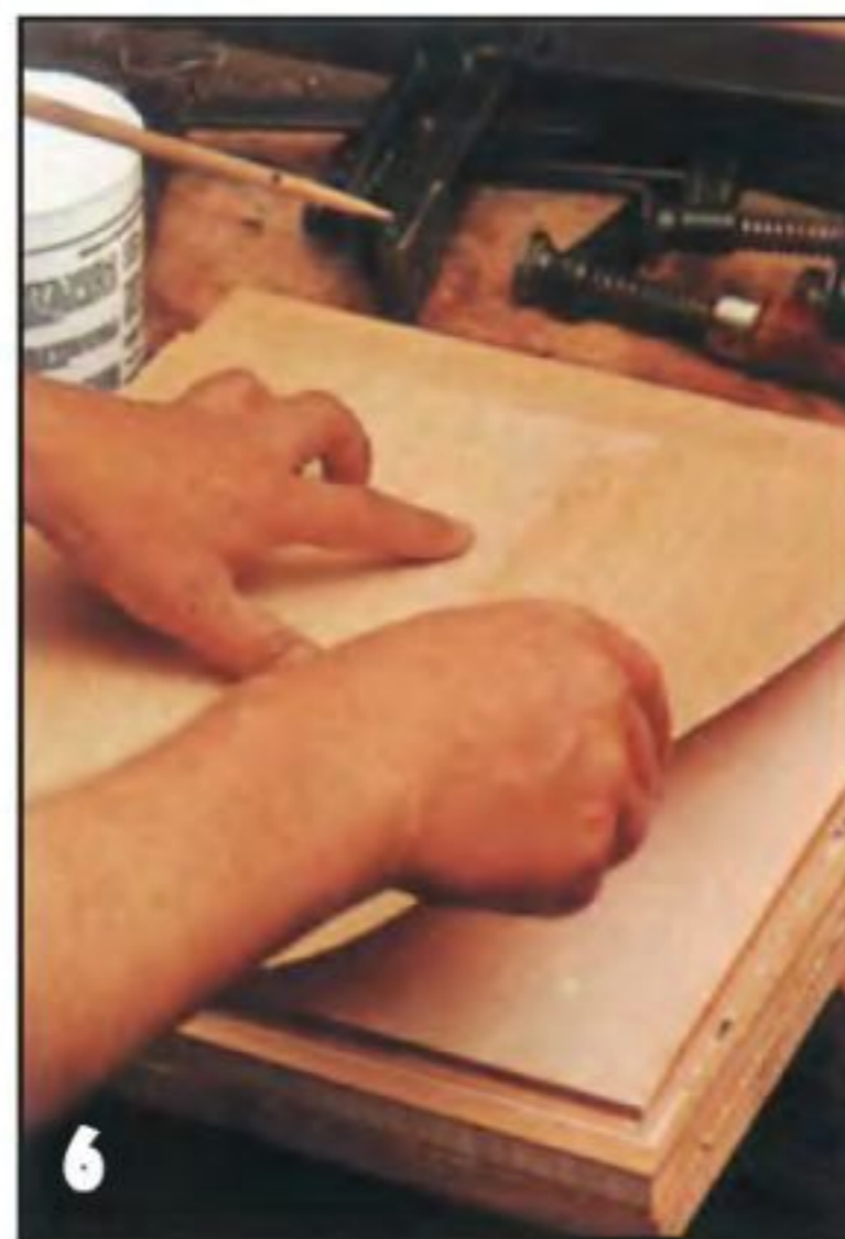
6 Чтобы избежать склеивания шпона с подкладкой, между ними кладут газету.
