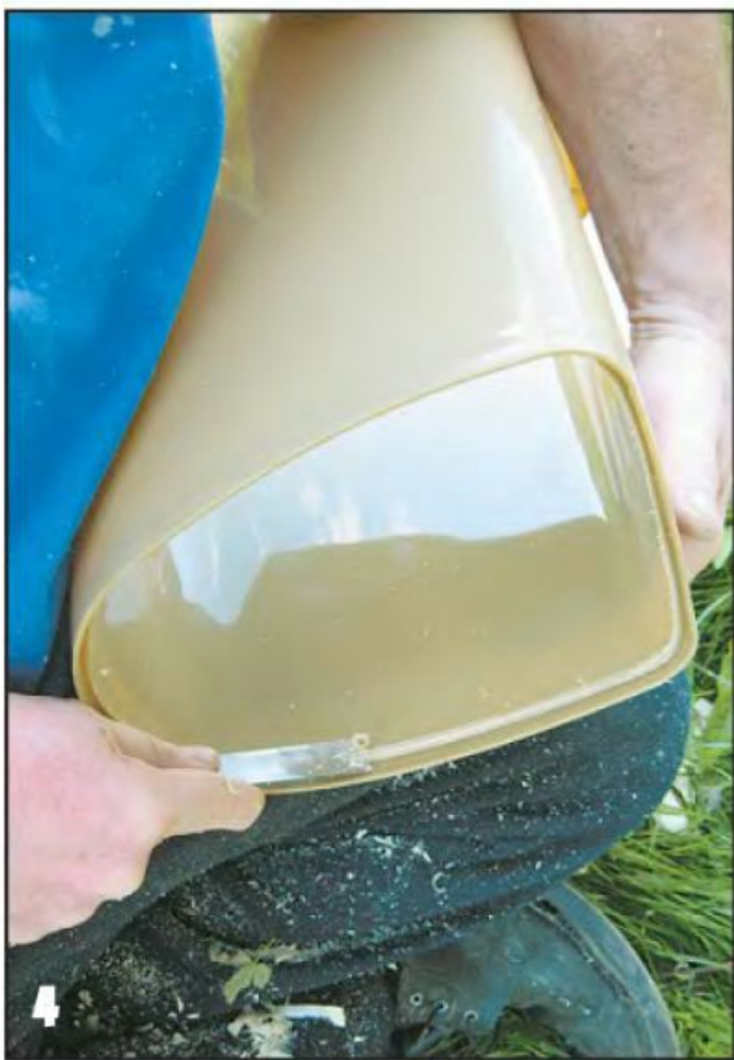
Окончательно выровняли и сделали гладкой внутреннюю кромку с помощью острой стамески.
