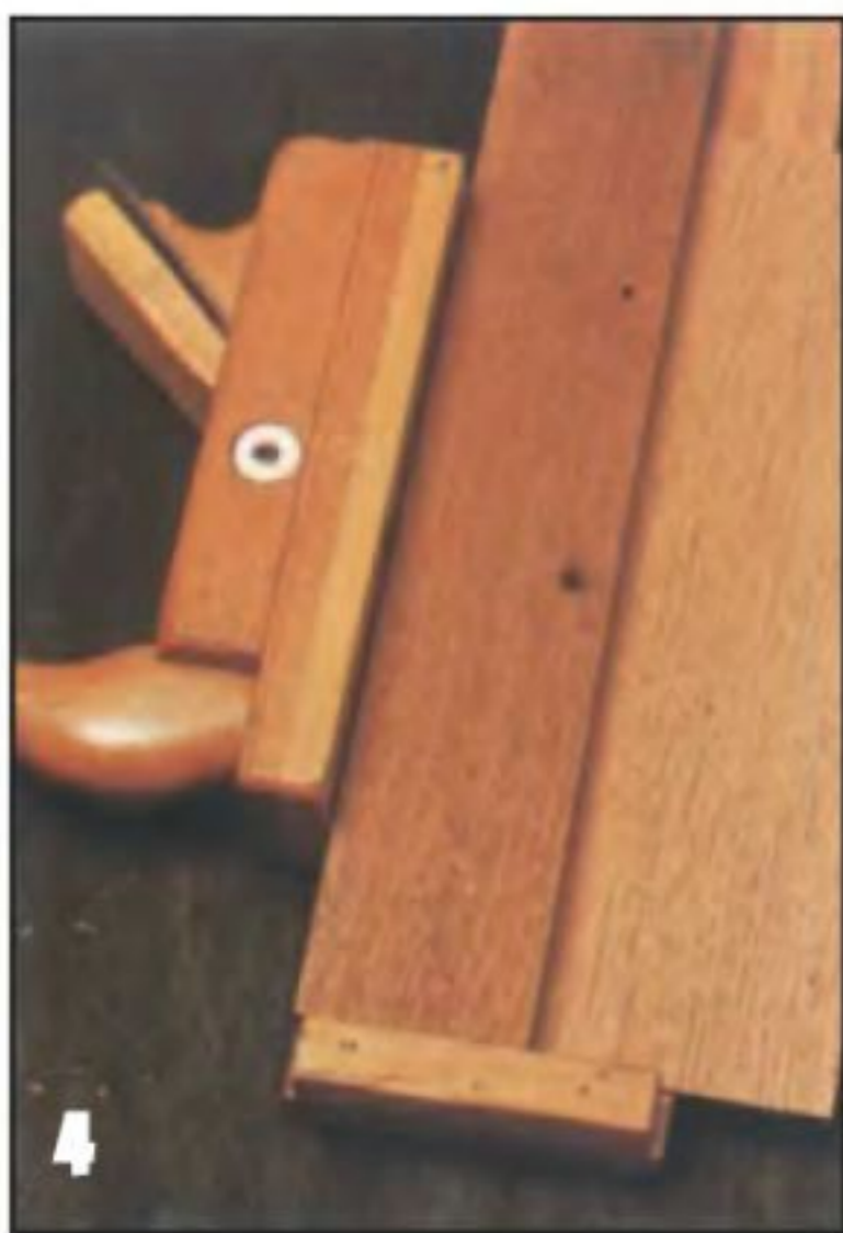
4 Лицевую панель для циферблата делают из фанеры. С обеих сторон её фанеруют.
