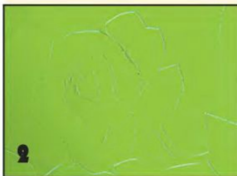
Плёнка с прорезанным рисунком (плоттер прорезает только верхний виниловый слой, не задевая бумажную подложку плёнки).
