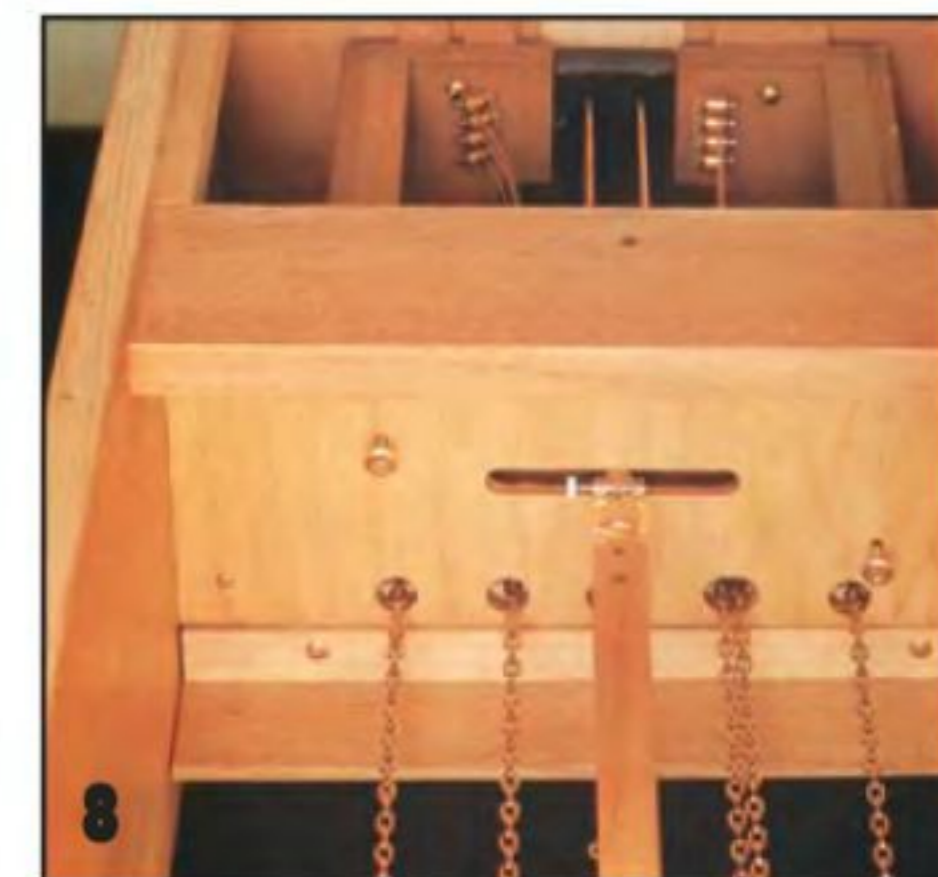
8 Вид на нижнюю полку. Отверстия в ней следует просверлить как можно точнее.
