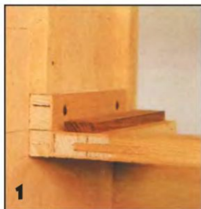
1 Опора для часового механизма. Поперечину соединяют с уголками.
