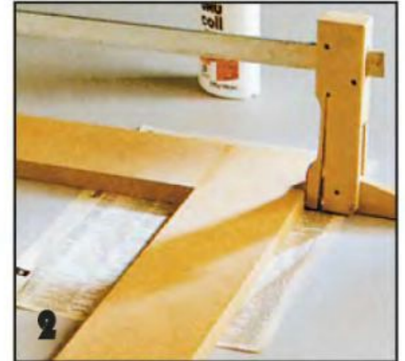
Полоса твёрдой ДВП, вставленная между двумя деталями направляющей, облегчает перемещение сменных лицевых панелей.
