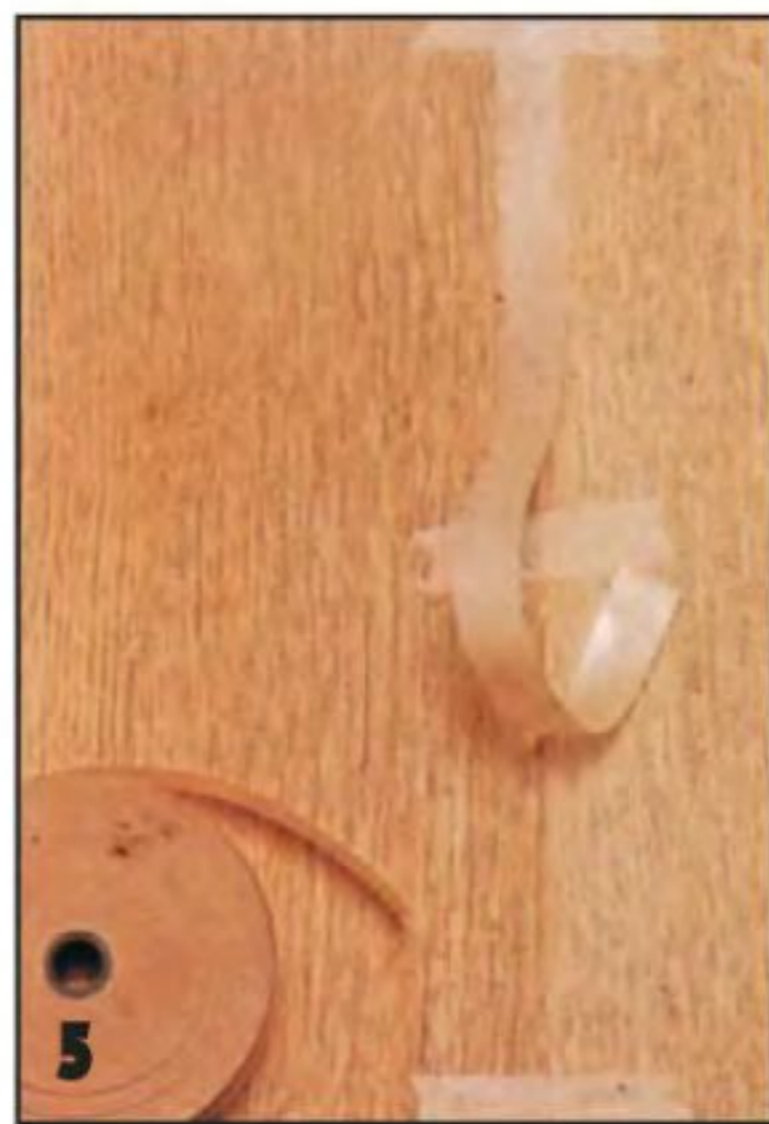
5 Чтобы шпон при спрессовке не сместился, стыки заклеивают специальной бумагой.
