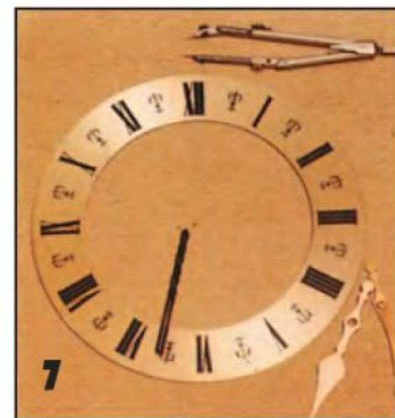
7 Определив центр для оси стрелок и наметив окружность, в лицевой панели сверлят отверстие.
