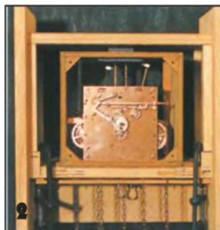
2 Временно вставляют часовую механизм, чтобы подогнать нижнюю полку.
