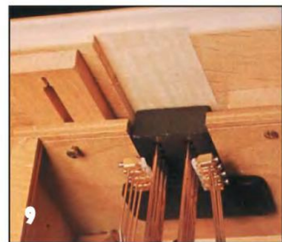
9 Привинчиваем дистанционные прокладки к верхней полке и юстировка закончена.
