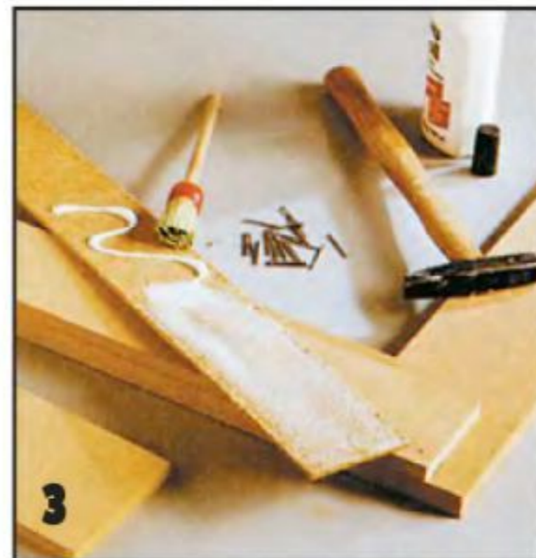
Направляющую для сменных лицевых панелей собирают из двух выкроенных из плиты MDF полос, одновременно придающих раме дополнительную жёсткость.
